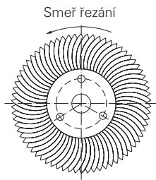
Způsob ozubení 4 jednostranne ozubení s ozubením na obvodu
