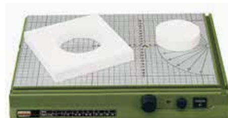
Pro řezání oblých tvarů je jednoduché řešení: připevníte (např. izolepou) napínáček ke stolu. Slouží jako otočný bod.
