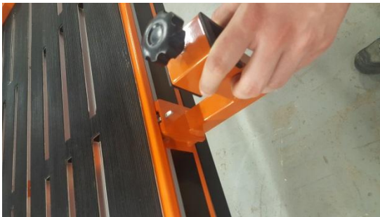
Pak vložte podpěru pravítka a pomocí šroubů uchyťte a dotáhněte
