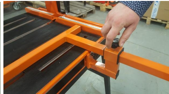
Fixujte dle potřeby pomocí horních šroubů
