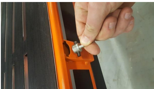
Vložte šrouby do otvorů rámu stroje
